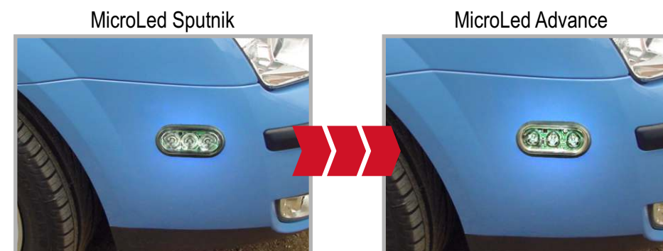
A Microled Advance és a Microled Sputnik teljesen felcserélhető elektromos csatlakozásokkal rendelkezik.
